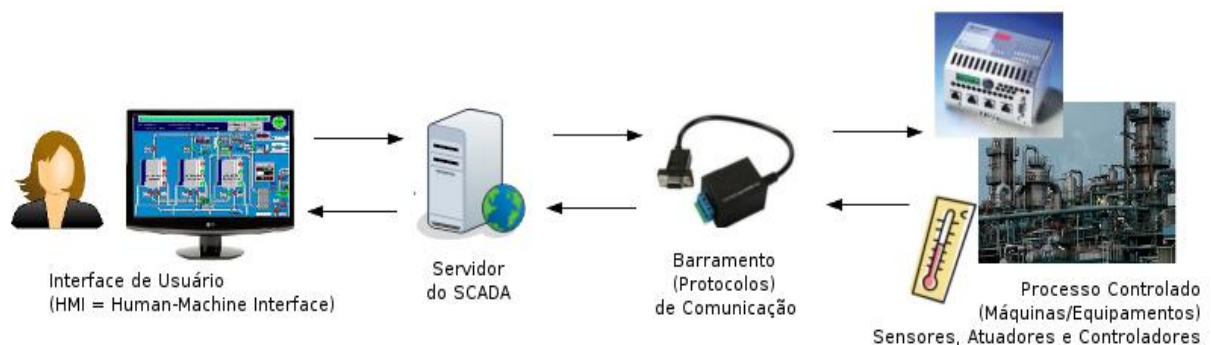
Figura 8 - Diagrama da automação de processo via ScadaBR. Fonte: Rocha (2011).
