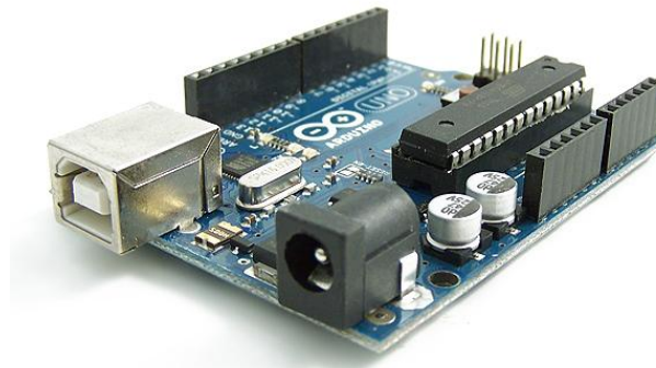
Figura 1 - Arduino UNO. Fonte: McRobert (2011)
