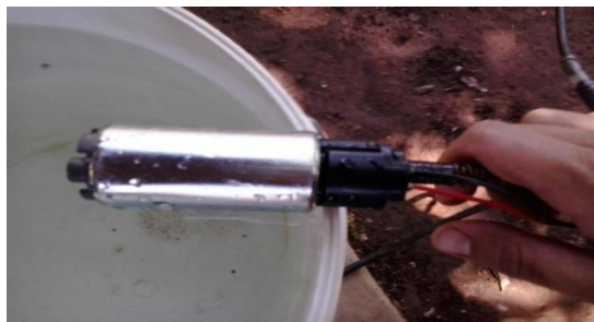
Figura 4 - Bomba de combustível automotiva. Fonte: Fonte própria (2013).
