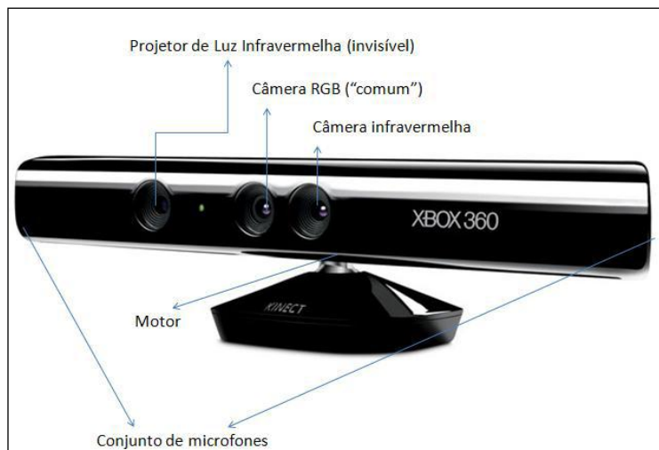
Figura 1: Arquitetura do Kinect
