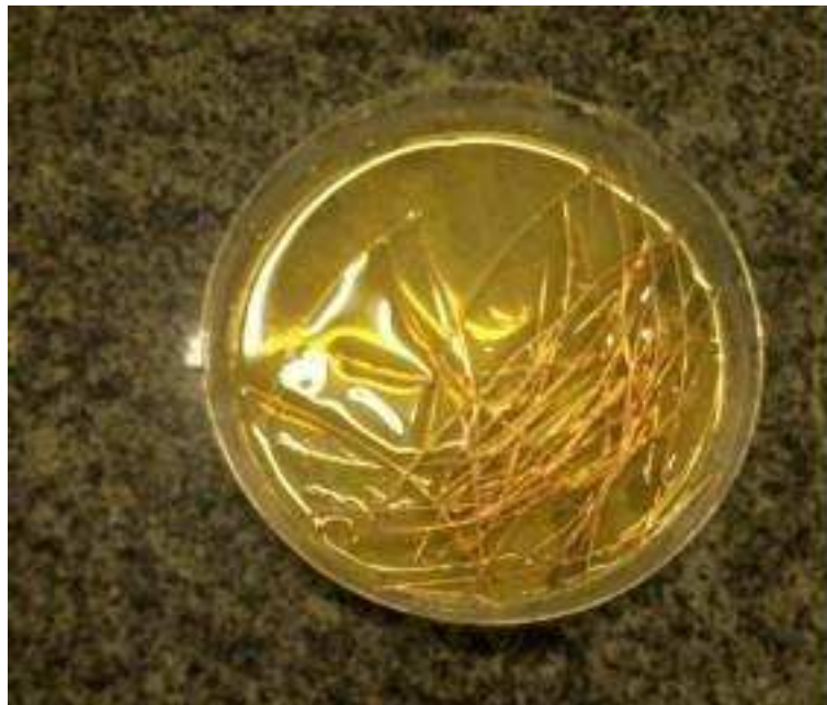
Figura 2 - Semeamento das Placas e Adição do Fio de Cobre Parcialmente
