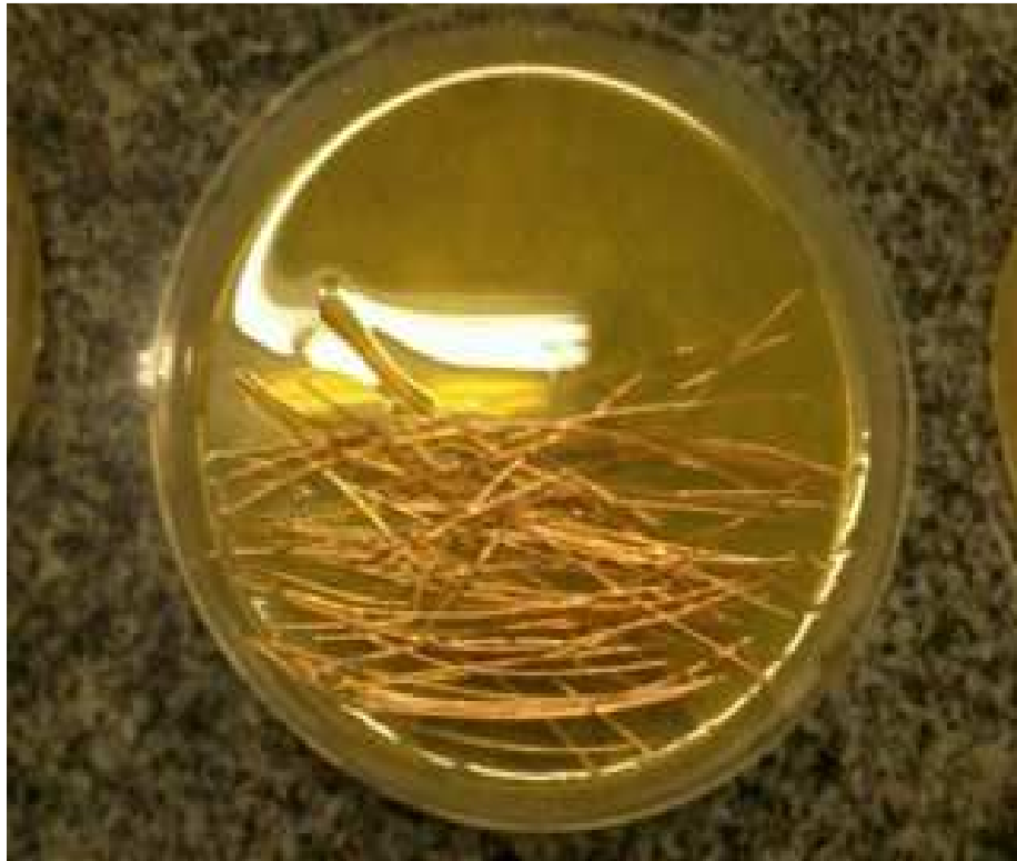
Figura 1 - Semeamento das Placas e Adição do Fio de Cobre Parcialmente
