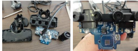
Figura 4 – Detalhes da Câmera utilizado e seu sensor CCD.
