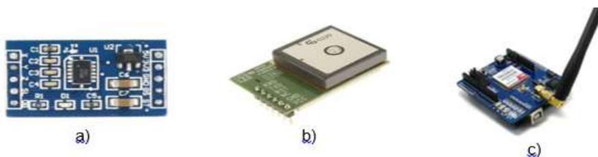
Figura 1 - a) Acelerômetro (MMA7361, 2008), b) GPS (SKM53, 2010) e c) GSM (SIM900, 2009)
