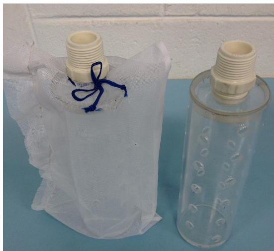
Figura 1- Filtro construído de leito rígido de acrílico com fibra poliéster
