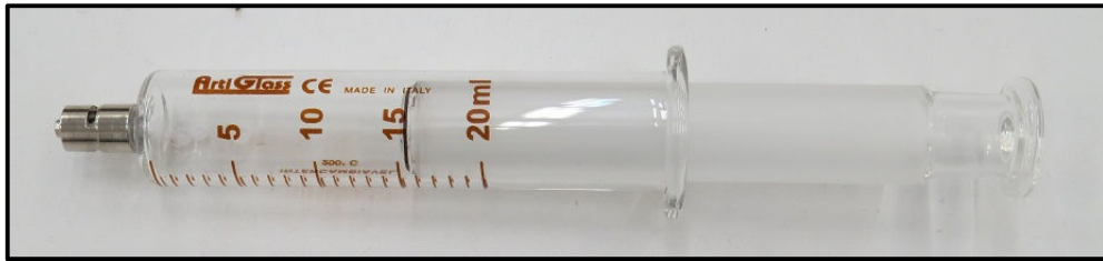
Figura 6: Seringa utilizada como cilindro e pistão.
