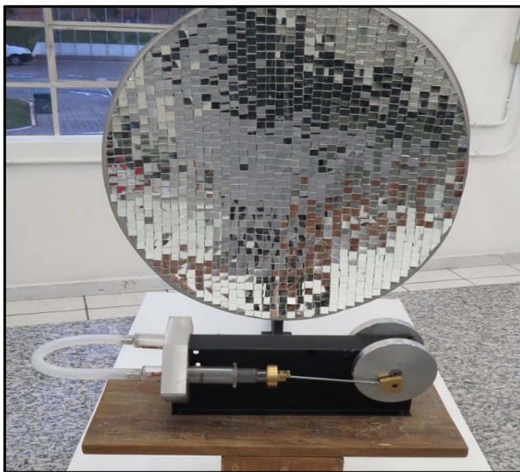
Figura 10: Conjunto concentrador solar e protótipo motor Stirling.
