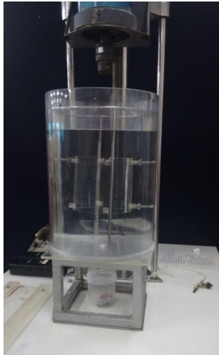
Figura 4 – Tanque equipado do acessório Draft Tube (2016)
