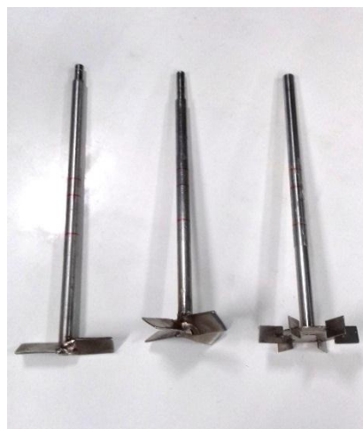
Figura 3 - Impulsores mecânicos de 2 pás axial, 4 pás axial e 6 pás planas radial respectivamente. (2016)
