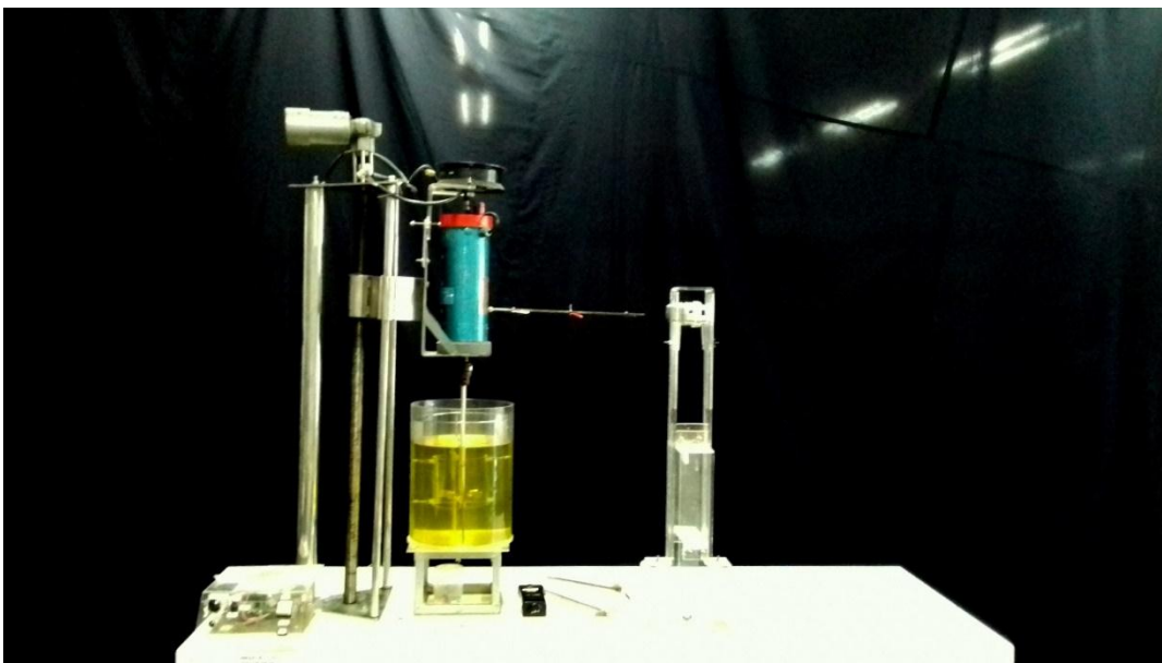
Figura 2 – Unidade piloto com tanque provido de agitação mecânica e draft tube. (2016)
