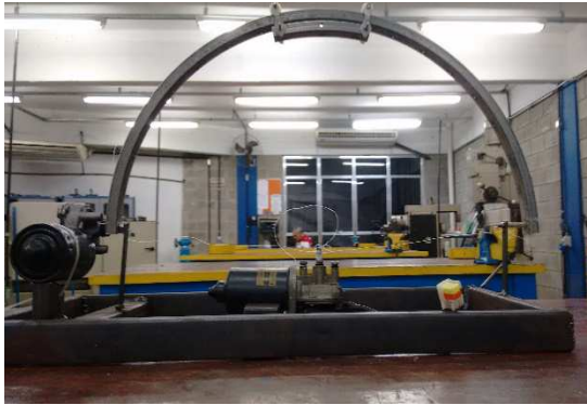
Foto 1 – Vista Lateral do Protótipo do Heliodon
