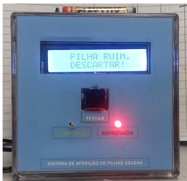
Figura 5 - Teste de uma pilha considerada ruim, no equipamento desenvolvido (AUTOR, 2017).
