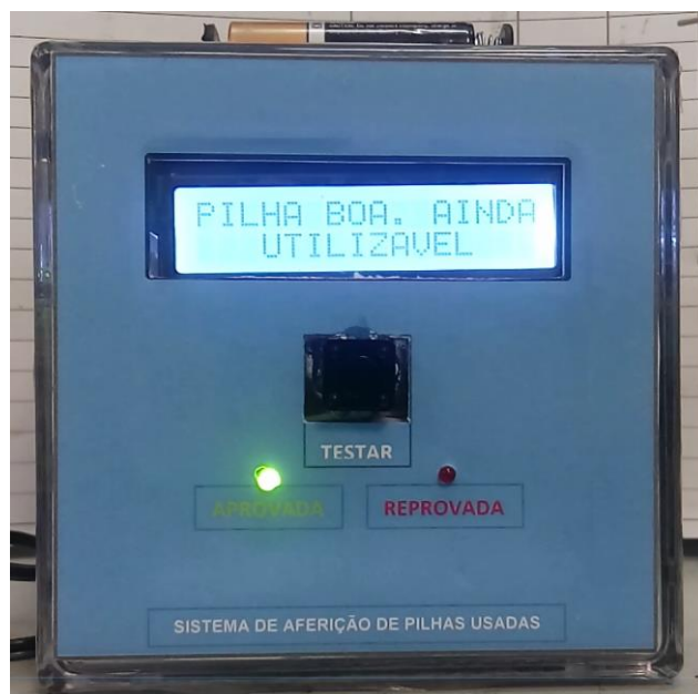
Figura 4 - Teste de uma pilha considerada boa, no equipamento desenvolvido (AUTOR, 2017).
