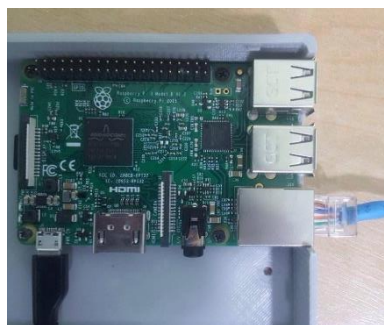
Figura 1 - Ligacões no Raspberry Pi 3.
