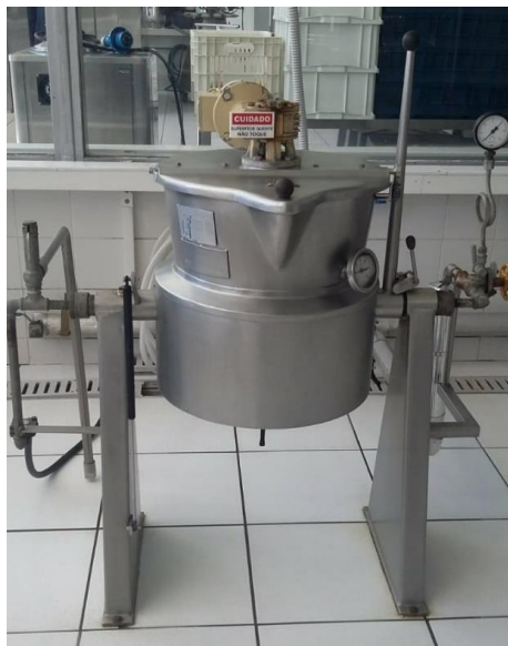
Figura 1- Tacho encamisado aberto de pastosos da planta piloto da FTT
